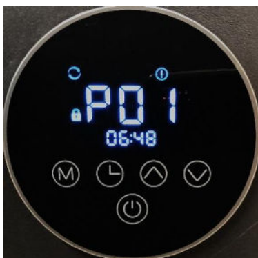
Fig. 13. No flow error displayed
